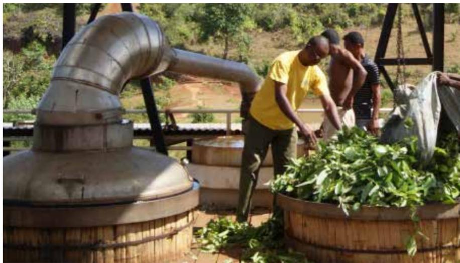
**Nos alambics** sont conçus pour économiser au maximum l'énergie par l'isolation thermique des cuves, le recyclage des fumées et de l'eau de refroidissement.
